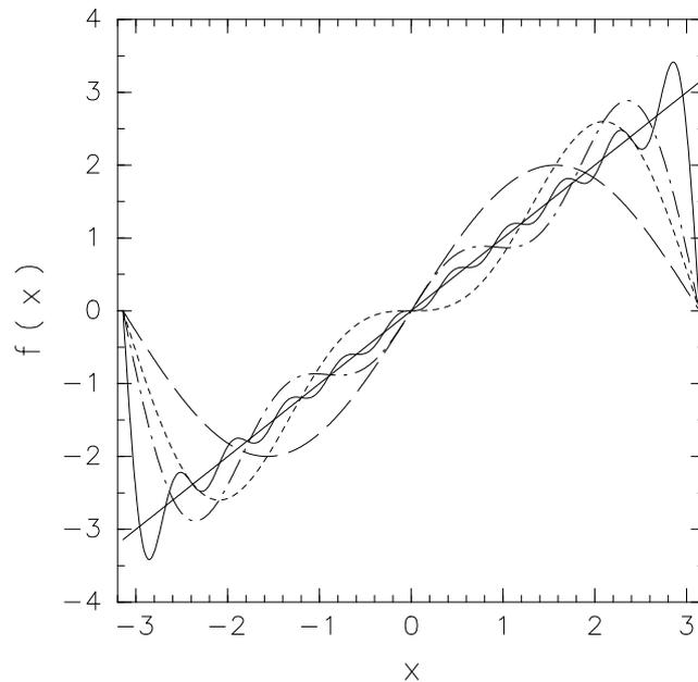
図 3.1 太実線は  $f(x) = x$ . 破線は  $f(x)$  の Fourier 級数展開の初項を，点線は  $f(x)$  の Fourier 級数展開の第 2 項まで，一点破線は  $f(x)$  の Fourier 級数展開の第 3 項まで，細実線は  $f(x)$  の Fourier 級数展開の第 10 項目までを図示した．
