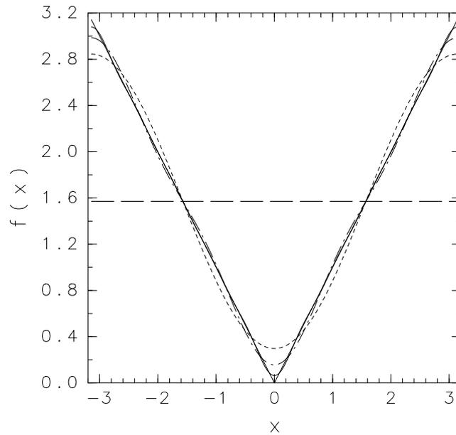
図 3.2 太実線は  $f(x) = |x|$ . 破線は  $f(x)$  の Fourier 級数展開の初項. 点線は  $f(x)$  の Fourier 級数展開の第 2 項まで. 一点破線は  $f(x)$  の Fourier 級数展開の第 3 項まで. 細実線は  $f(x)$  の Fourier 級数展開の第 10 項目まで.
