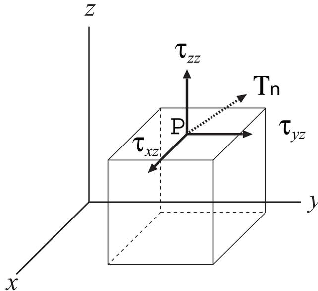
図 1.1 点 P を通る  $z$  軸に垂直な平面を考える. このとき, P に働く応力  $T_n$  は平面に水平な成分  $\tau_{xz}, \tau_{yz}$  と垂直な成分  $\tau_{zz}$  に分解できる.
