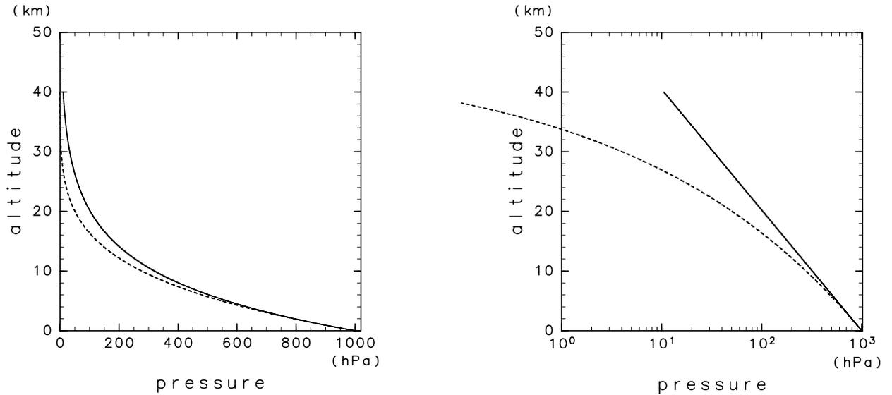
図 1: 等温大気 (実線) と等減率大気 (破線) における大気圧の鉛直分布.
